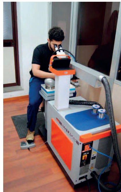
Saldatura con tecnologia laser.
