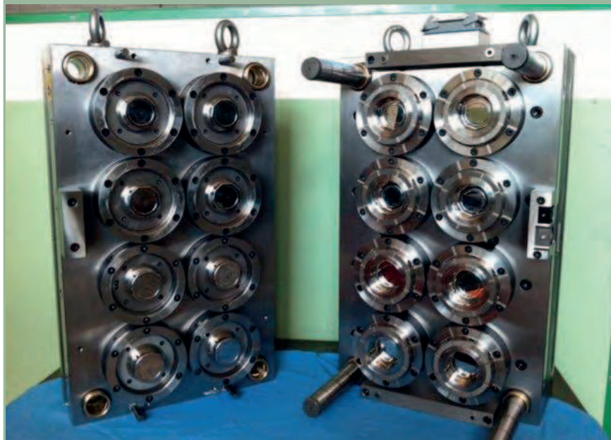
Stampo ad iniezione plastica multi impronta per contenitore alimenti progettato con VISI Modelling.
